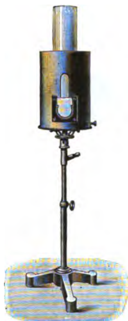
Fig. 109. — Lampe à gaz muni d'un bec Auer.
